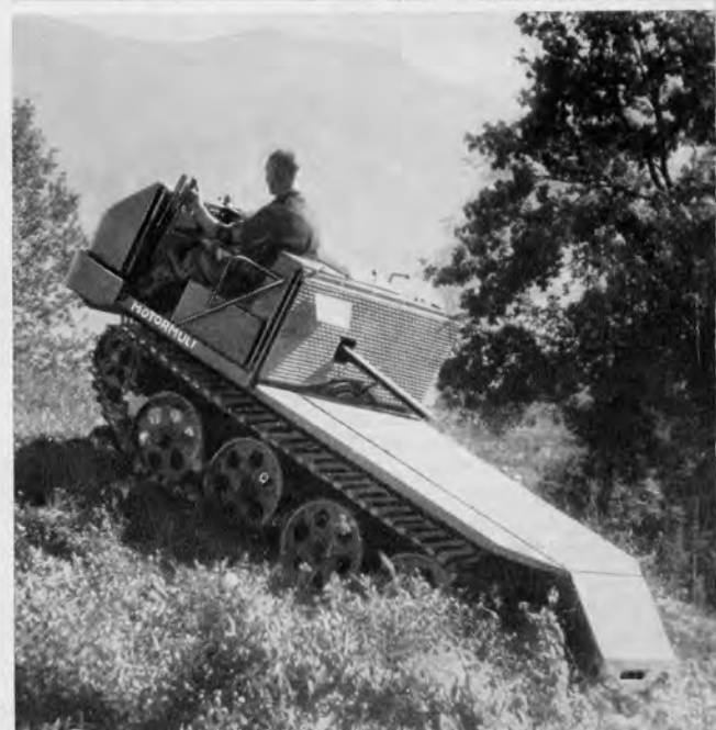
Bild 4 und Bild 5 Type M 70, „Universal“, mit Seilwinde und Drehrunge für die Holzbringung
