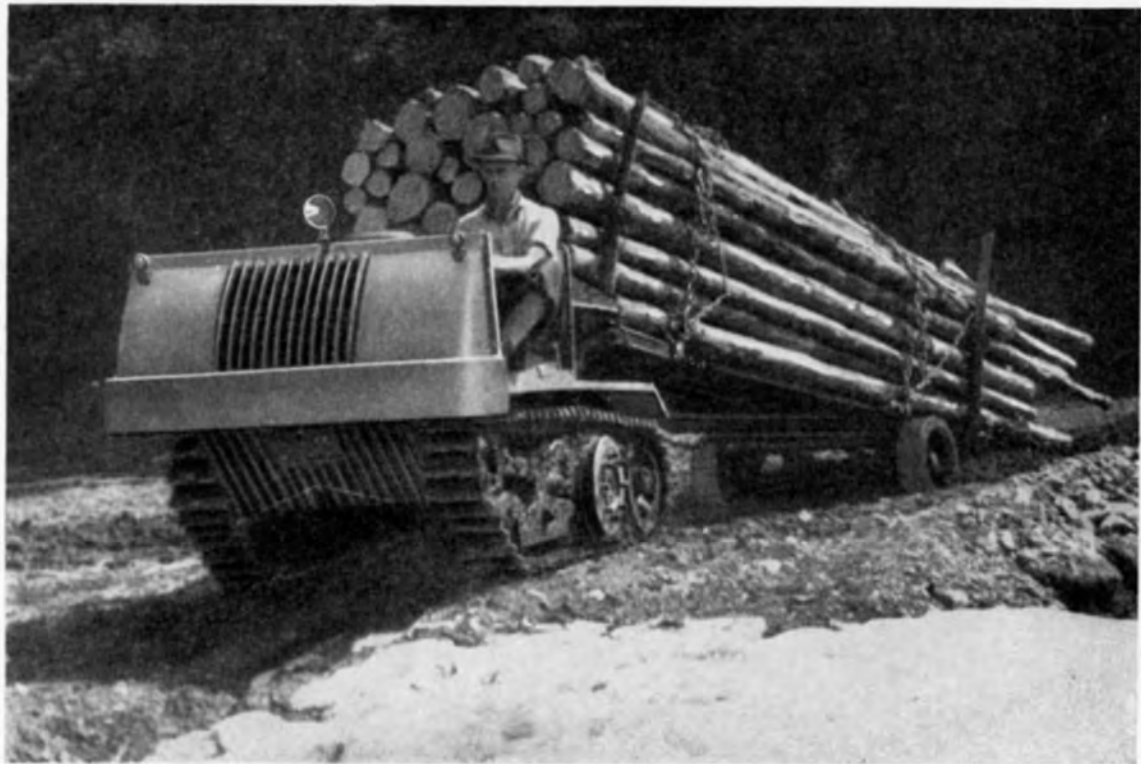
Motormuli M60 mit 6 fm Schleifholz auf Drehrunge
