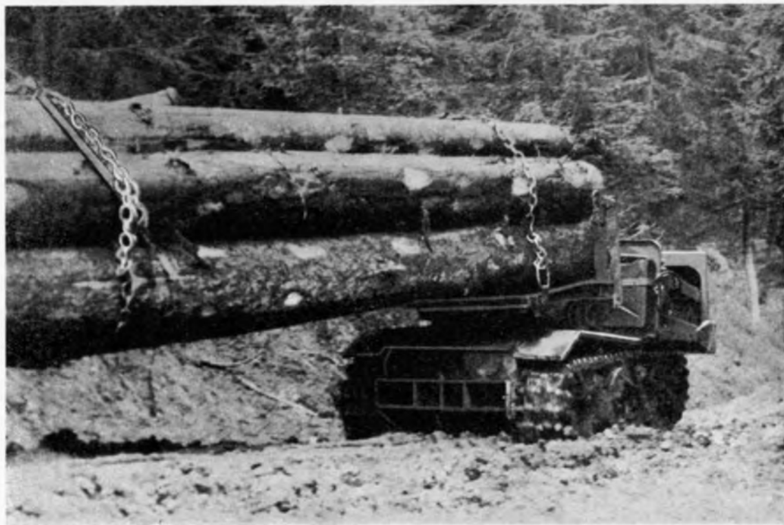
Motormuli M60 mit 8 fm Langholz auf Drehrunge
