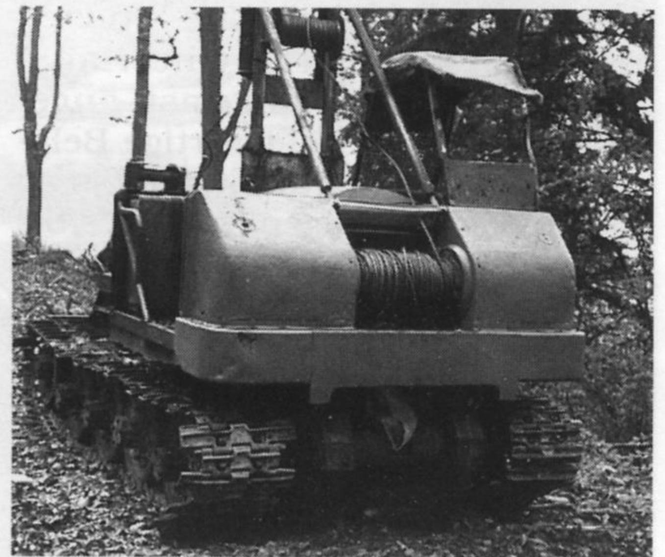
Ganz oben; Motormuli beim Belastungstest. Unten: Motormuli Type M 70 Universal mit Kran, Drehrunge und Nachläufer.
